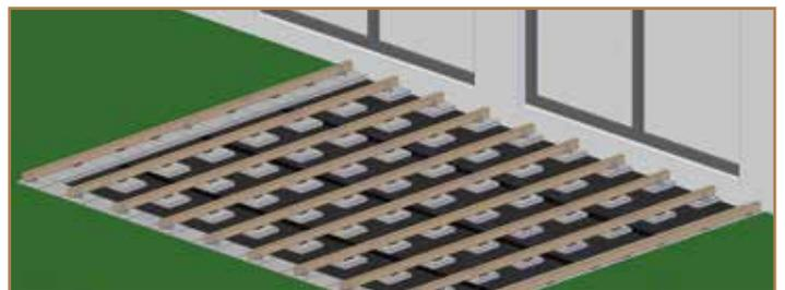
7. Befestigen Sie jede Unterkonstruktion z.B. mit Metallwinkel und Schrauben mindestens 3-mal (vorne - Mitte - hinten) auf den Betonplatten.
