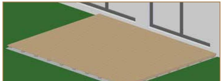
13. Die letzte Terrassendiele sollte ca. 10mm über die vordere Verblendung überstehen. Das Blendbrett sollte mindestens 1-mal an jede Unterkonstruktion befestigt werden.
