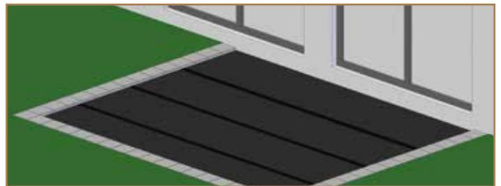
5. Unter jede Unterkonstruktion sollten bei 25mm starken Massivholzdielen am besten Betonplatten von 4x20x20cm mit ca. 50cm Abstand (Mitte - Mitte) gelegt werden. Bei 21mm starken Terrassendielen sollte der Abstand ca. 45cm betragen. Bei NFC/WPC/RMC-Produkten und bei modifizierten Materialien beachten Sie immer die Herstellerangaben.
