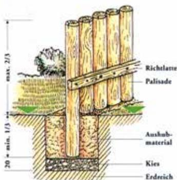
**Fachgerechter Einbau von Palisaden**
